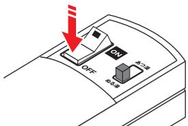
❗湯温を確認するときは必ず電源スイッチを切ってプラグを抜いて下さい
