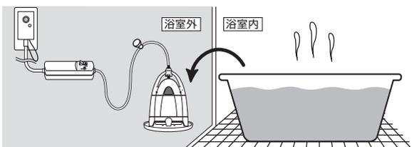
(使用時以外は、プラグをコンセントから抜き、本体を浴室外のトレイの上に立てる)
